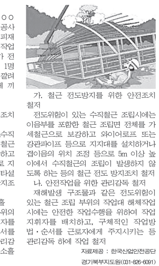
가. 철근 전도방지를 위한 안전조치 철저 전도위험이 있는 수직철근 조립시에는 이음부를 포함한 철근 조립면 전체를 가새철근으로 보강하고 와이어나이프 또는 강관파이프 등으로 지지대를 설치하거나 와이어나이프 또는 강관 파이프 등으로 지지대를 설치하거나 2단 콘크리트 타설 구간에 선 조립된 수직철근 전도방지조치를 미흡시나, 안전작업을 위한 관리감독 철저 재해발생 구조물과 같은 전도위험이 있는 철근 조립 부위의 작업대 해체작업 시에는 안전한 작업수행을 위하여 작업 지휘자를 배치하고, 구체적인 작업방법·순서를 근로자에게 주지시키는 등 관리감독 하에 작업 철저 자료제공: 한국산업안전공단 경기북부지도원(031-826-6091)
